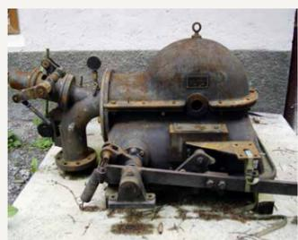
Bei diesem Posten befindet sich das Kleinkraftwerk Schmelze. Es gehört der Gemeinde Schmitten und ist noch immer in Betrieb. Das kleine Kraftwerk hat eine grosse Wirkung. Im Überlauf der Trinkwasserversorgung wird Strom produziert, der zirka einen Viertel des Strombedarfs der Gemeinde deckt.
